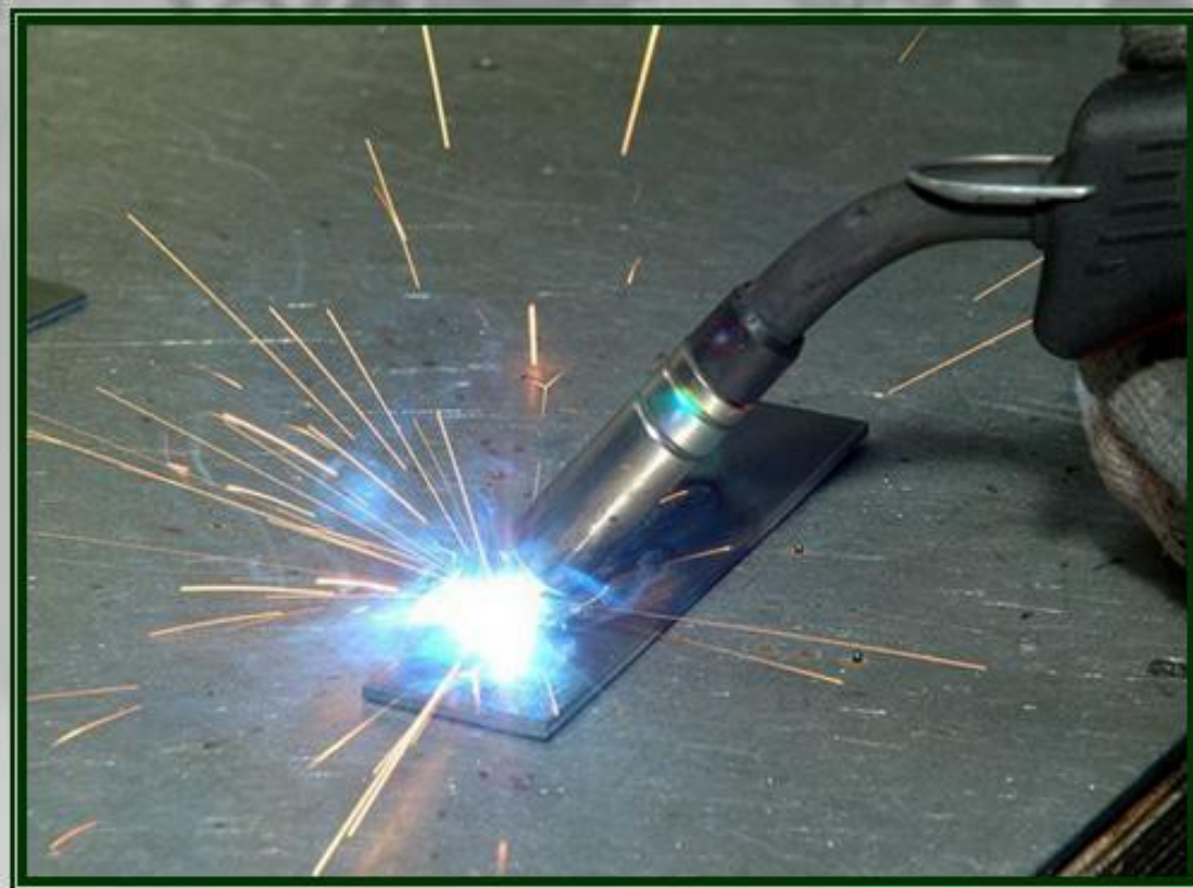
Автоматическая сварка открытой дугой
